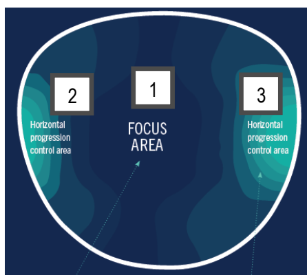
Figura 1 : Estructura esquemática de una lente de control de la miopía de control de la miopía
