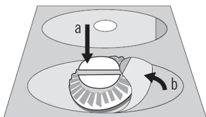
Il supporto di bloccaggio viene incollato alla pellicola tramite il biadesivo e quindi tirando la linguetta reso solidale alla pellicola stessa. La pellicola anti scivolamento e il pezzo di bloccaggio vengono quindi applicati insieme sul lato convesso della lente.
