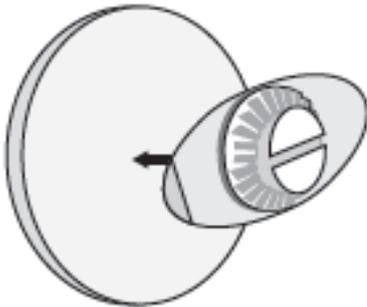
Setzen Sie das Brillenglas in Ihren Formrandungsautomaten ein und bearbeiten Sie dieses wie gewohnt. Nach dem Formranden ziehen Sie die Folie ab. Bitte verwenden Sie keine scharfen Gegenstände zum Entfernen der Antislipfolie, da die Oberfläche leicht beschädigt werden kann.
